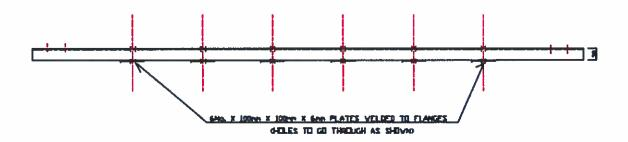
LV FUSE BAR, STEEL U- CHANNEL (2290mmX100mmX50mmX6mm)
